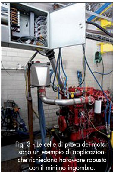
Fig. 3 - Le celle di prova dei motori sono un esempio di applicazioni che richiedono hardware robusto con il minimo ingombro.
