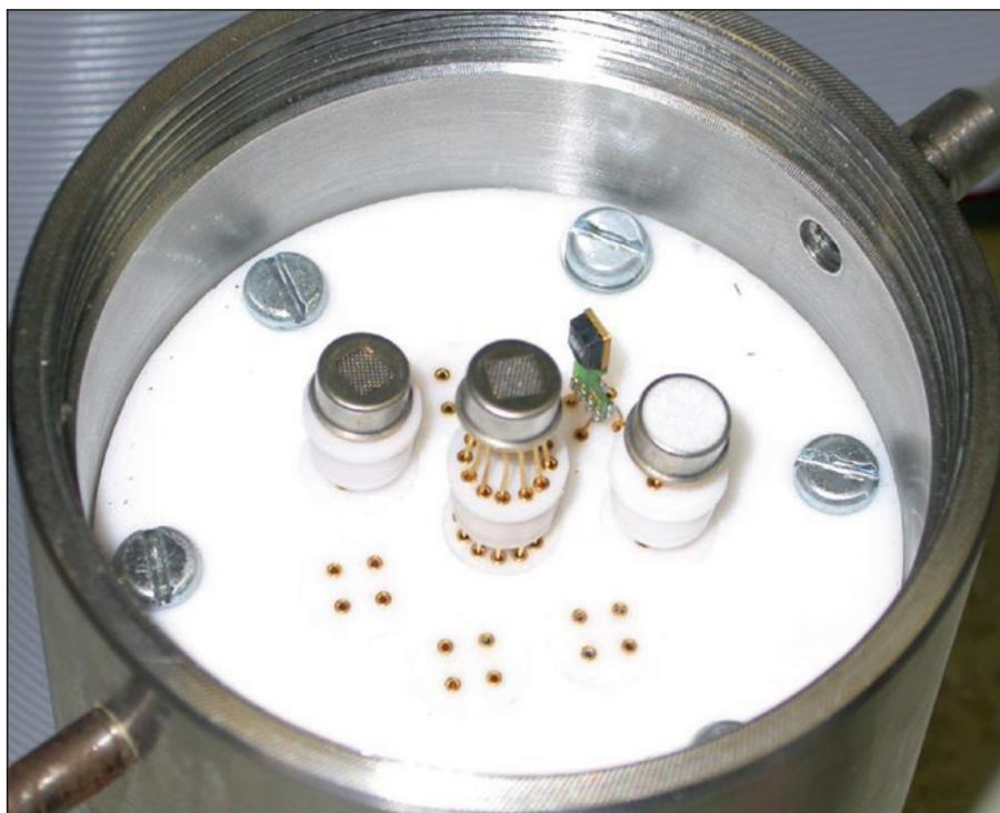
Fig. 2 - Cella di misura del naso elettronico dotata di tre sensori di gas alloggiati ed il sensore di temperatura ed umidità.
