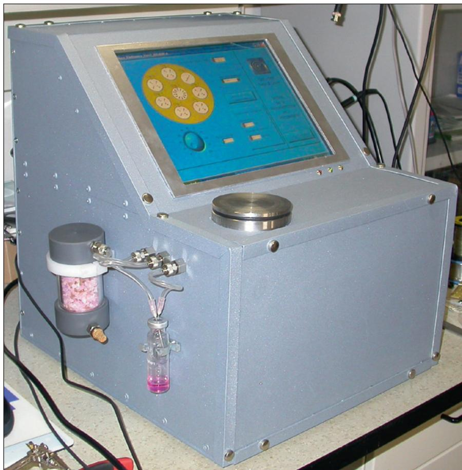
Fig. 1 - Il naso elettronico realizzato al CNRS-IMM.
