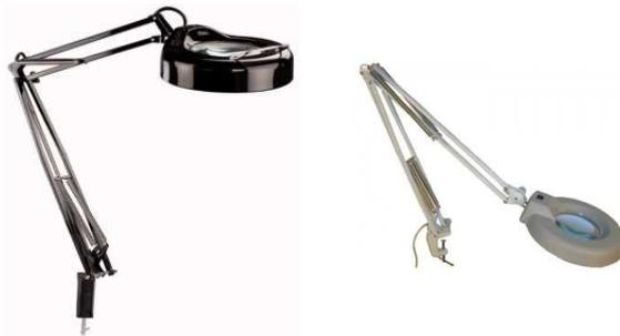
Altra attrezzatura molto utile è la lente con luce annessa che permette l'analisi del lato piste in modo da poter valutare la presenza di cortocircuiti, piste interrotte e saldature malfatte.
