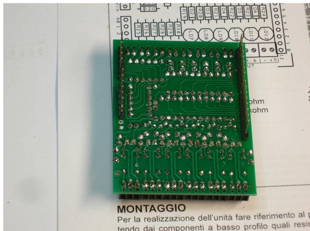
Vista completa del lato componenti e scheda già inserita sulla scheda Arduino.
