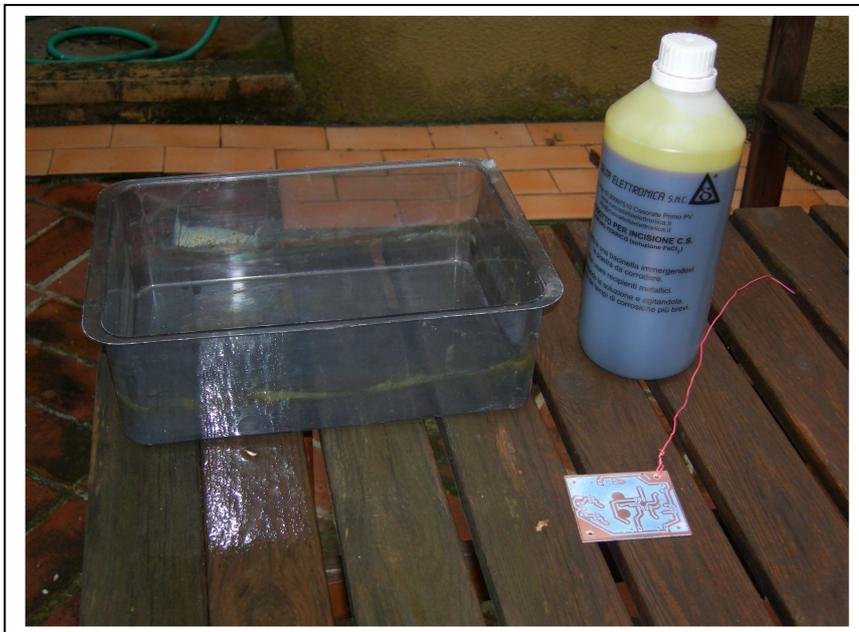
Si deve fare un foro su un angolo della piastra a cui si lega un filo di rame ricoperto che permetterà di muovere il circuito all'interno della vaschetta in modo da accelerare il processo di corrosione. Anche l'esposizione al sole, e quindi il riscaldamento, accelera questo processo.
